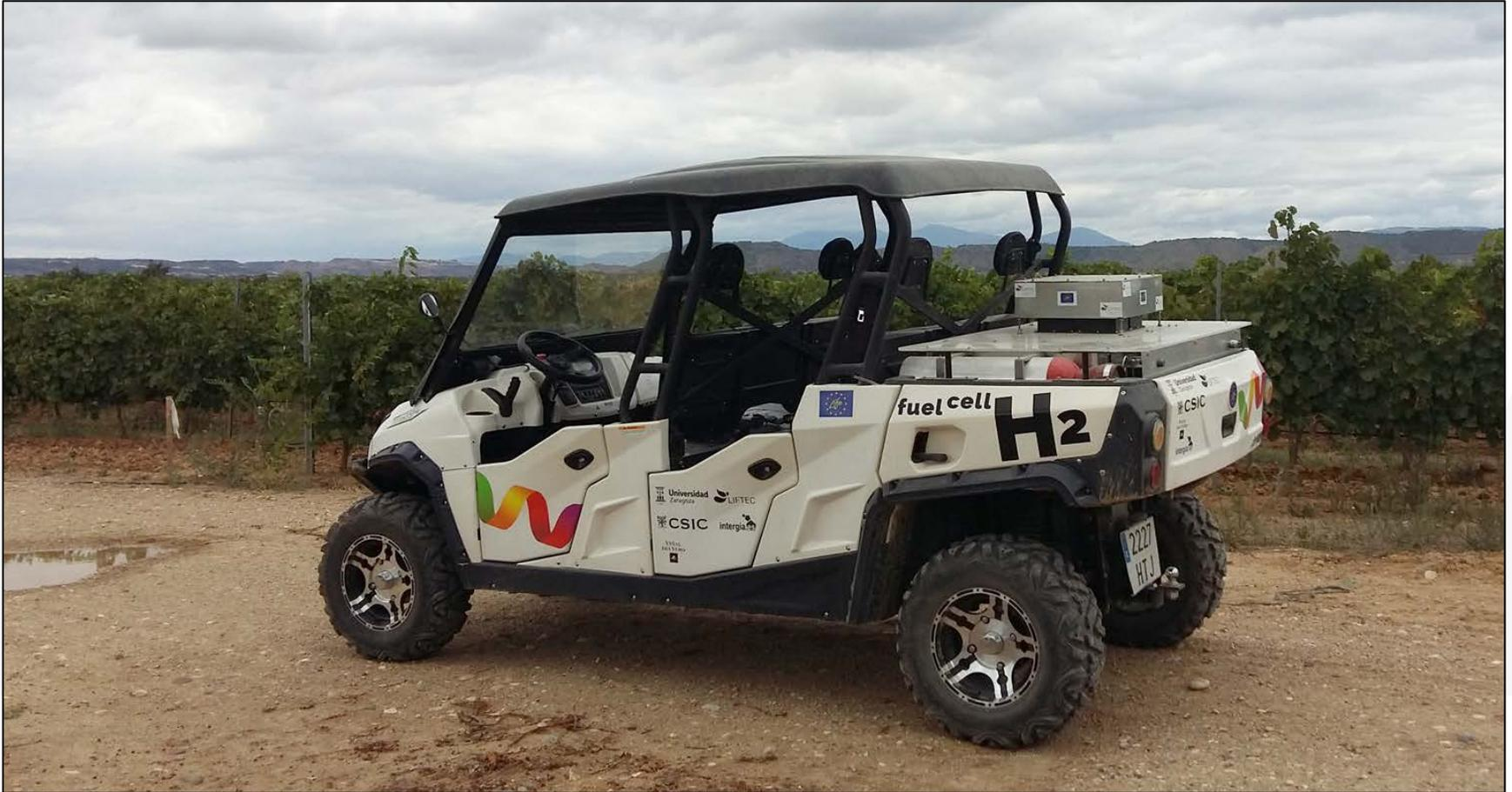
**Vehículo con pila de combustible de hidrógeno**
